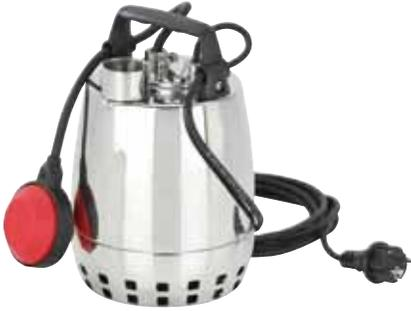
Pompe inox à roue multi-canaux ouverte avec double garniture mécanique en oxyde d'alumine/carbone dur, dans chambre à huile.
